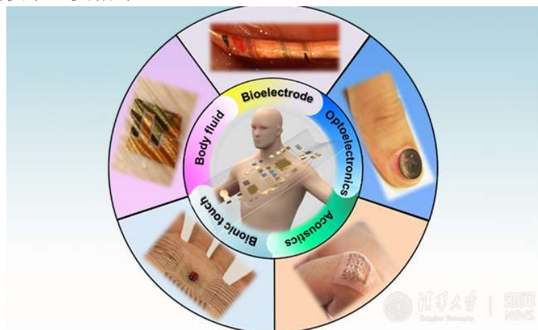
图为 用于生理参数监测的柔性混合电子: 柔性生理电器件、柔性光电器件、柔性声学器件、柔性类皮肤功能器件和柔性生化检测器件
